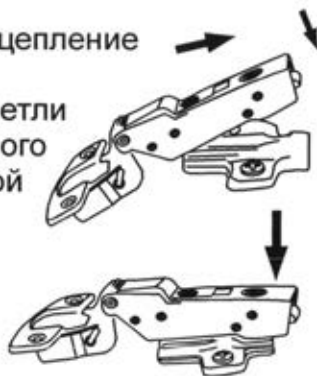
Схема монтажа петли.
